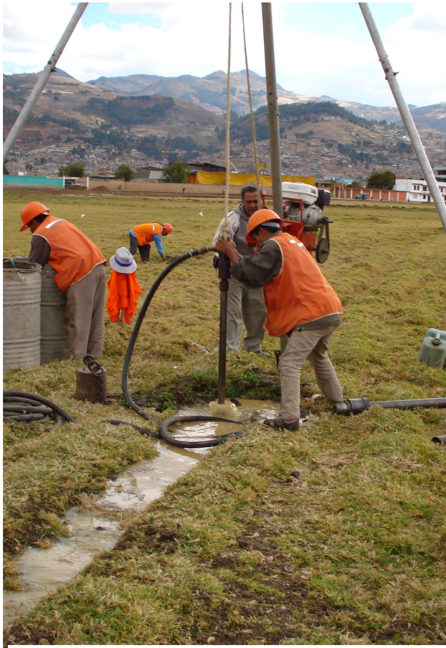
Sondajes con ejecución de ensayos SPT a cada metro de profundidad
