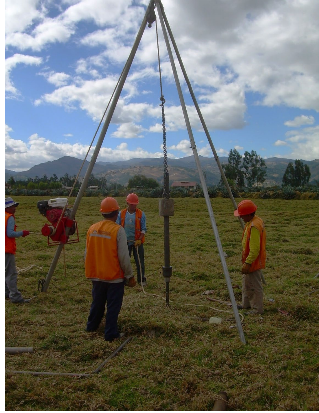
Sondajes con ejecución de ensayos SPT a cada metro de profundidad
